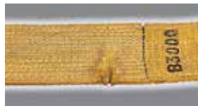
Повреждение основного шва
