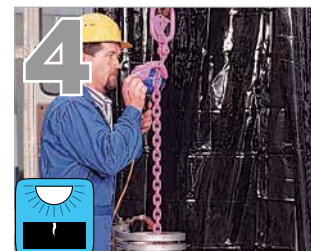
4 ПРОВЕРКА НА НАЛИЧИЕ ТРЕЩИН
