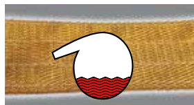
Повреждение в результате воздействия кислоты/щелочи
