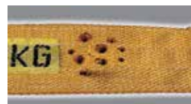
Повреждение в результате воздействия высокой температуры
